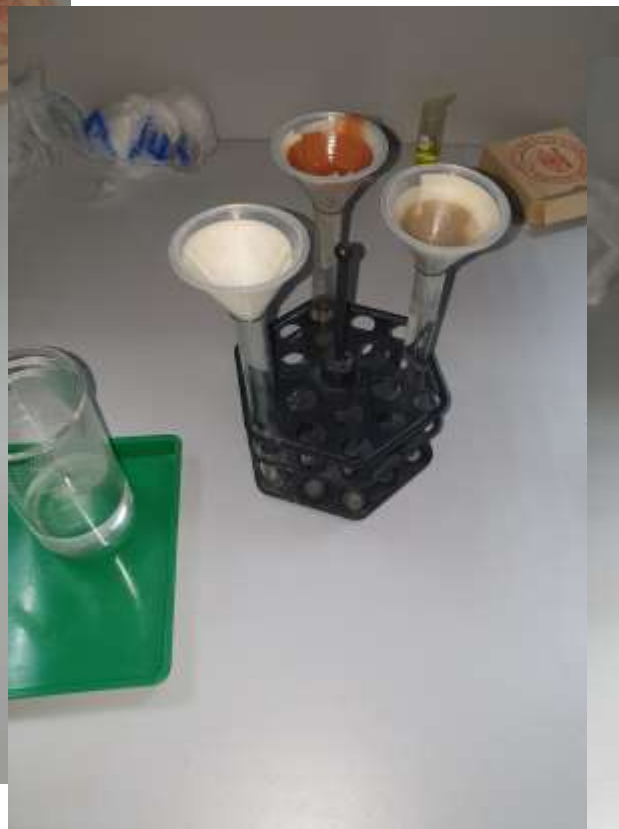
Эксперимент № 1 (фильтрация грунта верхнего, среднего и нижнего слоя)
