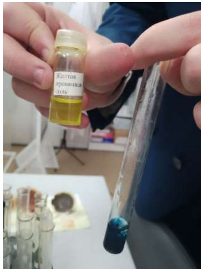
Эксперимент № 2. Реакция с красной кровяной солью (гексацианоферратом калия K_3[Fe(CN)_6] ) на ионы железа 2+ .
