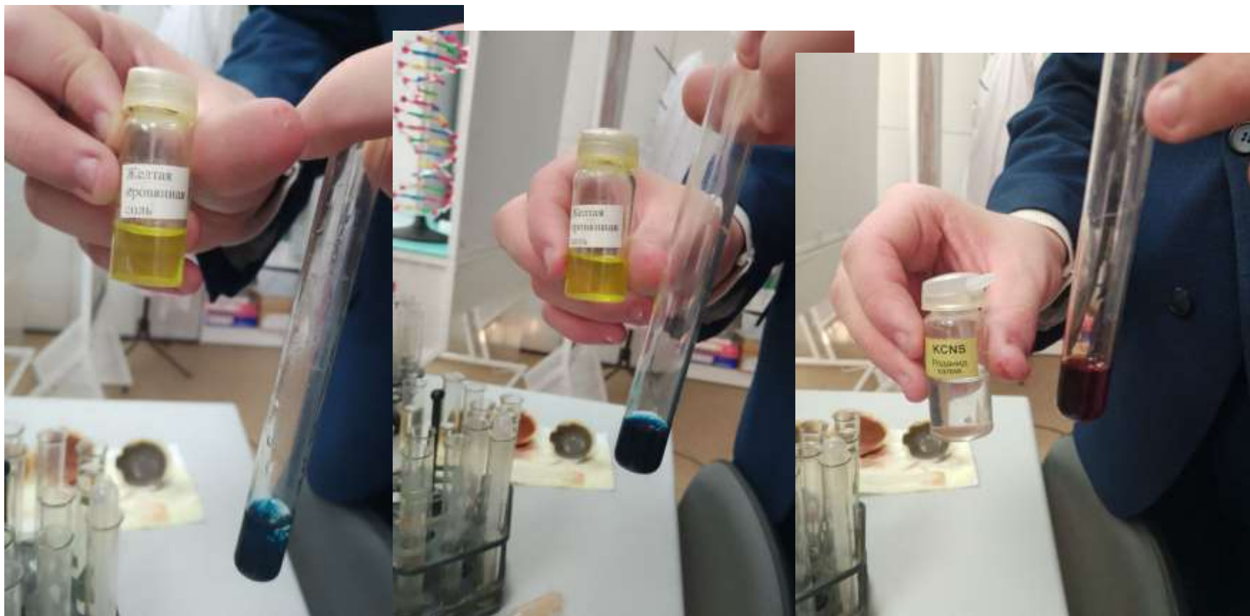
Качественные реакции на ионы железа 2+ и 3+ фильтратов каждого слоя после растворения в кислоте (эксперимент 2).
