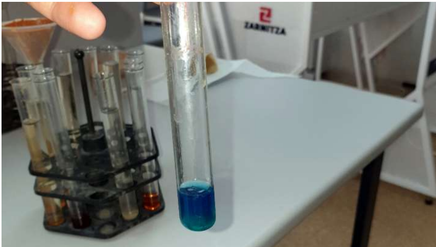
Эксперимент № 1 Реакция с красной кровяной солью (гексацианоферратом калия K_3[Fe(CN)_6] ) на ионы железа 2+
