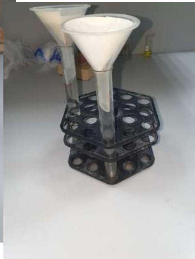
Эксперимент № 1 (фильтрация грунта верхнего, среднего и нижнего слоя)
