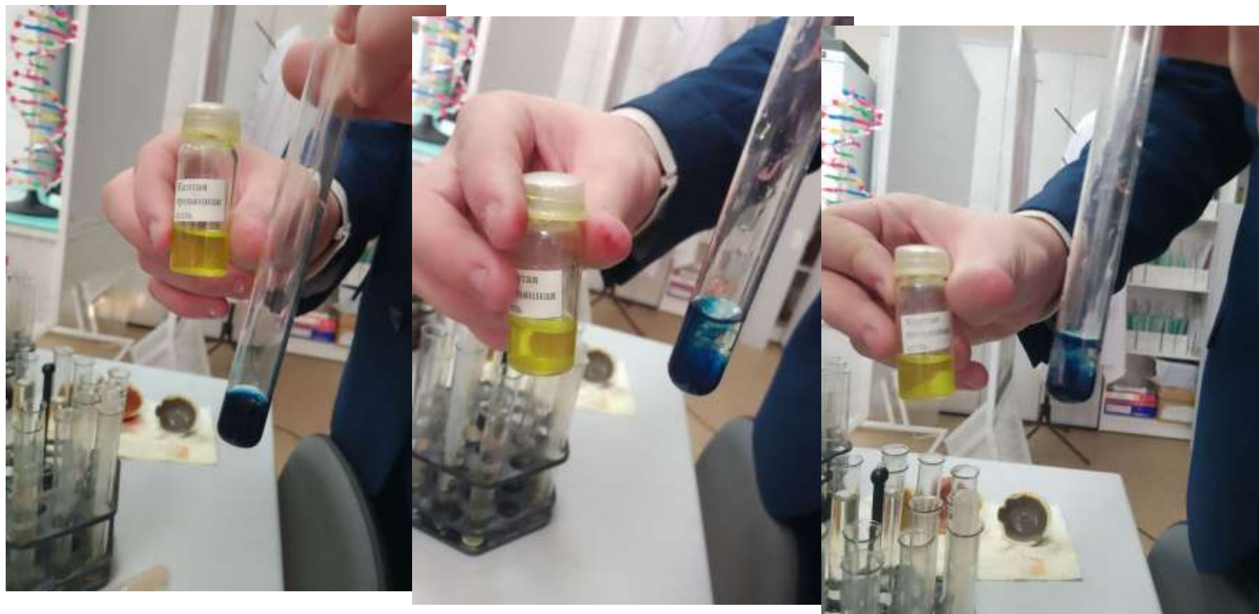
Эксперимент № 2. Реакция с жёлтой кровяной солью (гексацианоферратом калия K_4[Fe(CN)_6] ) на ионы железа 3+ .
