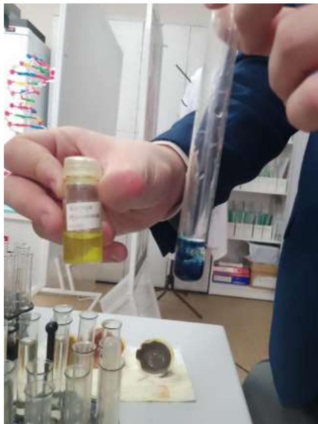
Эксперимент № 2. Реакция с красной кровяной солью (гексацианоферратом калия K_3[Fe(CN)_6] ) на ионы железа 2+ .
