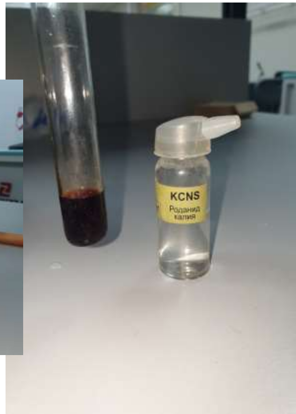
Эксперимент № 1. Определение ионов железа 3+ роданидом калия .
