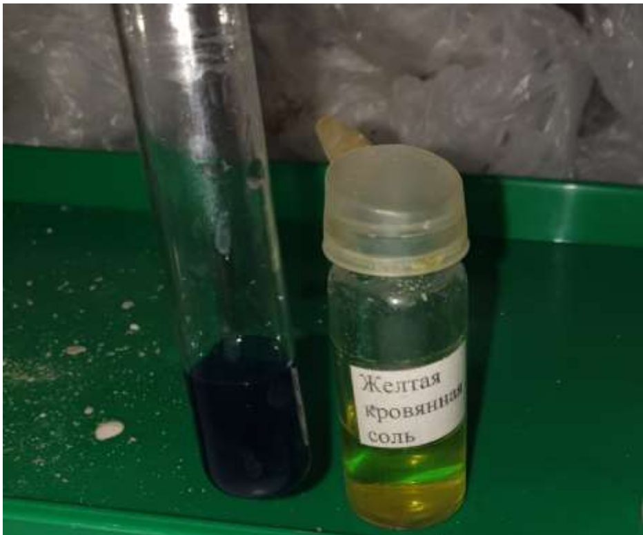
Эксперимент № 1 Реакция с жёлтой кровяной солью (гексацианоферратом калия K_4[Fe(CN)_6] ) на ионы железа 3+ .
